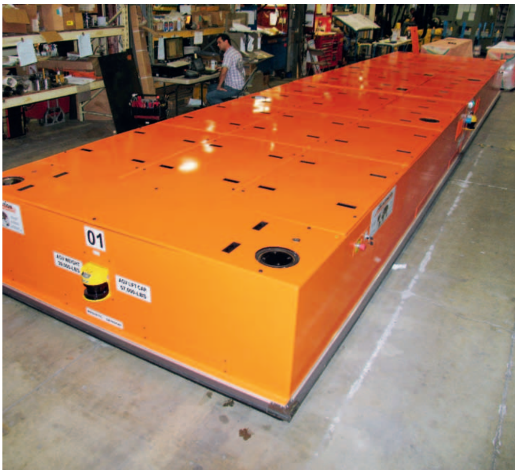
Gli AGV di Fori Automation sono imponenti: scatole rettangolari metalliche dal peso di 25 tonnellate, lunghe 12 m e larghe 5 m
