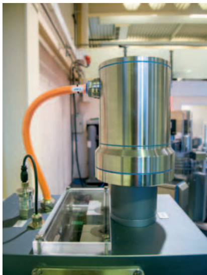
Per impianti destinati al settore farmaceutico o alimentare, Swiss Can Machinery utilizza i servomotori in acciaio inossidabile Akmh di Kollmorgen
