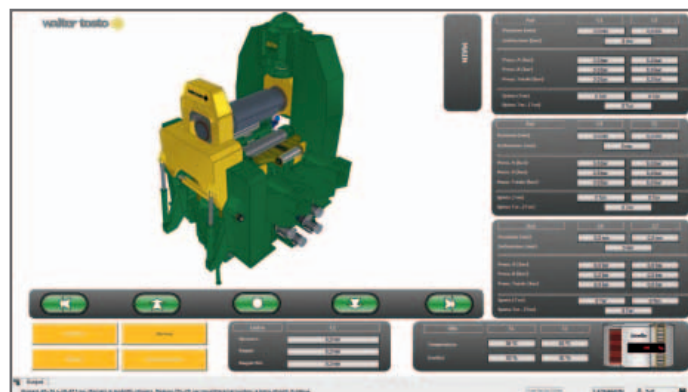
Il sistema di supervisione che controlla la macchina per le calandre più grandi del mondo è basato su Movicon 11
