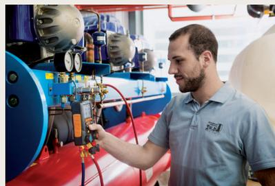
ratori Testo 550 e 557 sono perfetti per controllare unità di condizionamento dell'aria, impianti di refrigerazione e pompe di calore. Sono strumenti capaci effettuare misure, registrazioni, regolazioni ed analisi dei dati per controllare lo stato di funzionamento degli impianti e programmare attività di manutenzione preventiva. Questi strumenti vanno ad aggiungersi agli oltre 600 prodotti firmati Testo già presenti nel catalogo Conrad.
