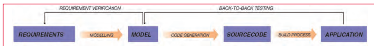
Fig. 1 - Schema di riferimento raccomandato per lo sviluppo basato su modelli [5]
