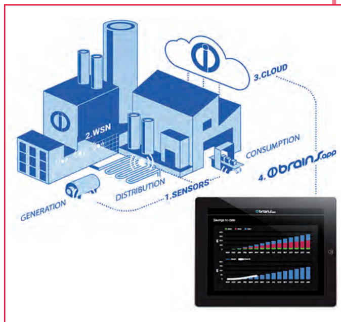
Fig. 3 - Dare impulso al cambiamento - Strumenti di analisi software, come il software Brains. App di IntelliSense.io, utilizzano i dati generati da reti di sensori wireless industriali per ottimizzare le operazioni e la resa dello stabilimento oltre a migliorare la sicurezza
