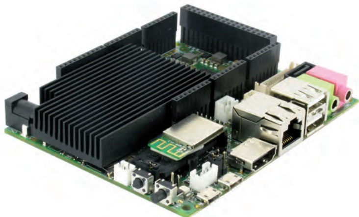
Fig. 3 - UDOO è una potente scheda basata su un core doppio o quadruplo ARM cortex-A9 CPU con un processore ARM dedicato
