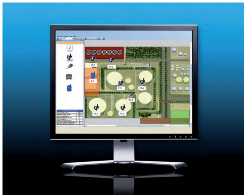
Fig. 2 - Visibilità della rete - Un software di gestione della rete offre visibilità cruciale della funzionalità della rete wireless come nel caso di questa utility SNAP-ON di Emerson Process Management
