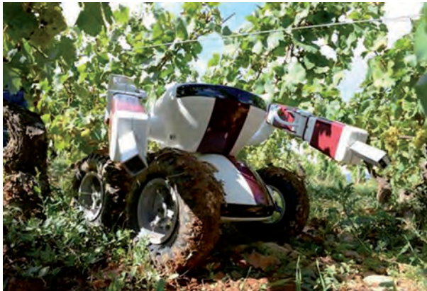
Fig. 2 - Con il robot Wall-E è possibile eseguire la potatura dei rampicanti
