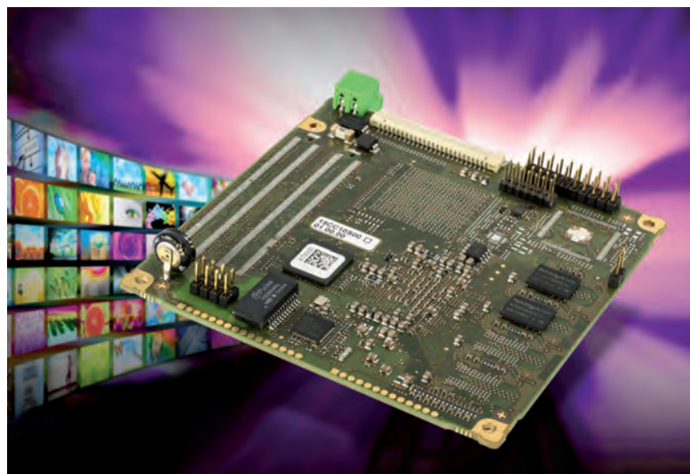
Fig. 1 - Una scheda SBC compatta (95 mm x 95 mm) adatta per ambienti severi, con funzionalità di controller multi-display (Fonte: MEN Mikro)
