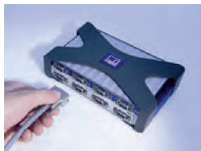
Fig. 3 - QuantumX MX840 di HBM usato per acquisire i dati durante le prove di caduta
