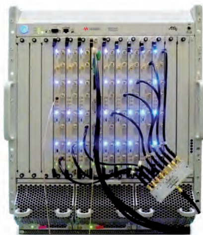
Fig. 1 - Il sistema di acquisizione dati multicanale a elevate densità con 64 canali sincroni caratterizzati da particolari requisiti sulla coerenza della fase, è composto da otto digitalizzatori AXIe ad alta velocità a 12 bit M9703A inseriti in un cestello AXIe a 14 slot M9514A
