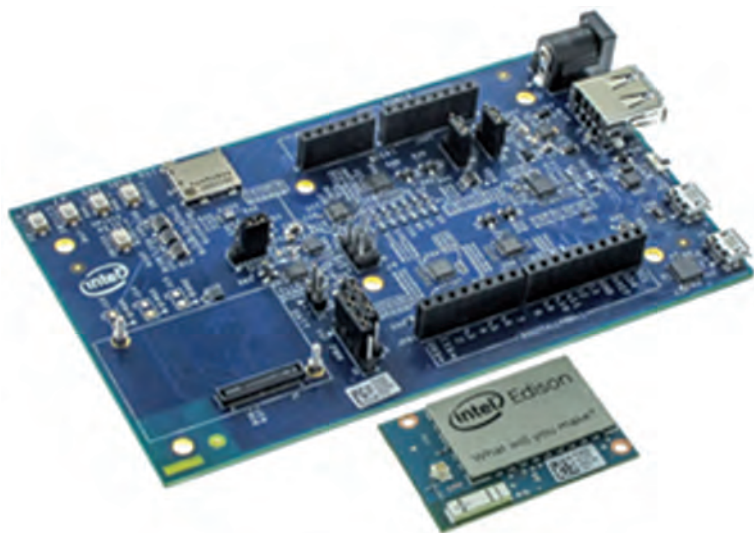
Fig. 3 - Le schede Edison di Intel per Arduino sono destinati agli utenti di Arduino. Queste sono simili ad Arduino Yun (Arduino Sketch, Linux, WiFi & BT) e compatibili con Arduino Uno (Fonte: Mouser Electronics)
