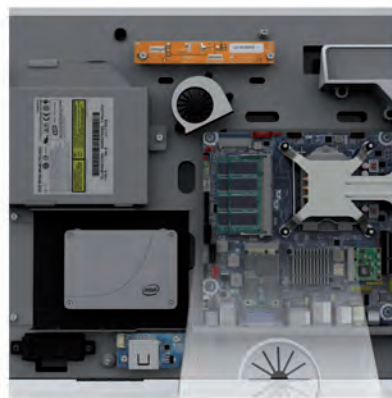
Fig. 3 - Un PC all-in-one compatto, basato su scheda Mini-ITX (Fonte: Intel)
