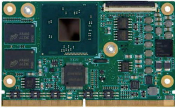
Fig. 2 - Il Low-energy Embedded Computer Adlink LEC-BTS in formato Smarc Short Size Module con CPU Intel Atom a core singolo, doppio o quadruplo
