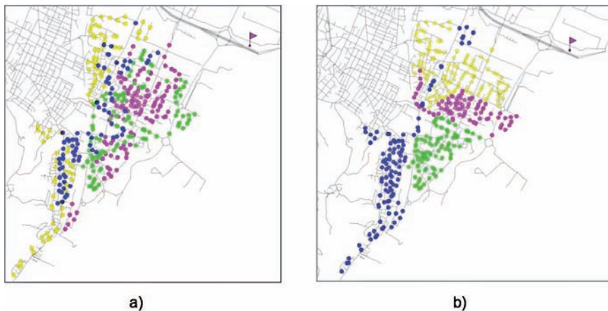
Figura 2 - Confronto tra soluzione ottenuta con il solo algoritmo di routing (a) e la soluzione ottenuta con clustering seguito dal routing: quest'ultima è circa 0,5% più lunga ma visibilmente più compatta.
