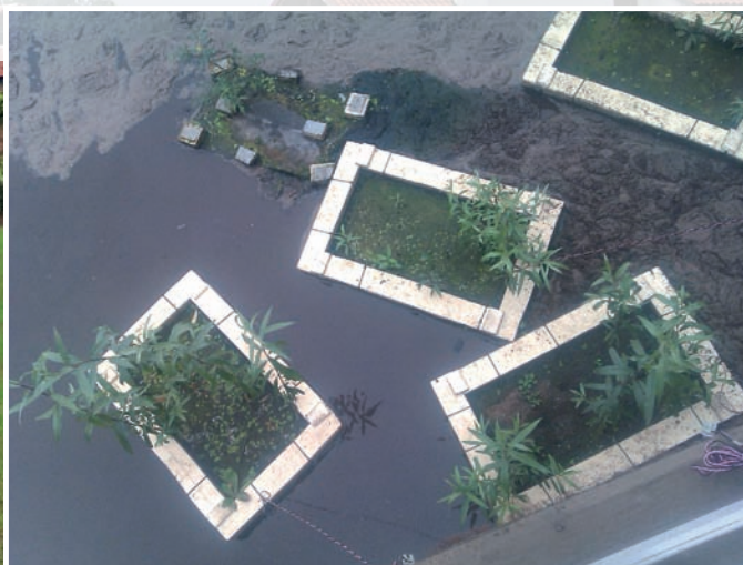
Figura 1 - Celle a combustibile microbiche in sperimentazione in una vasca di depurazione dell'impianto Milano-Nosedo.
