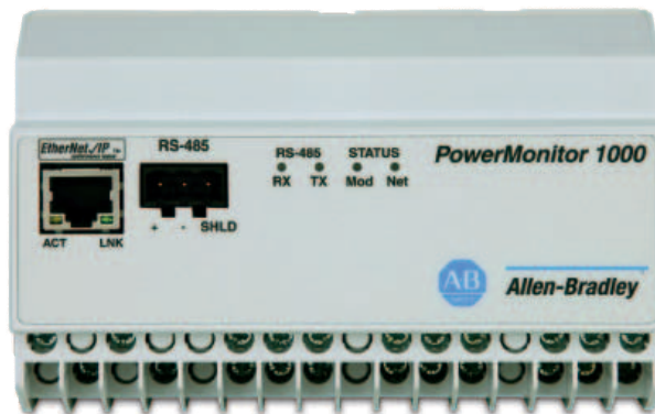
Un Allen-Bradley PowerMonitor 1000 è interfacciato ai PAC Rockwell Automation attraverso protocollo Ethernet/IP
