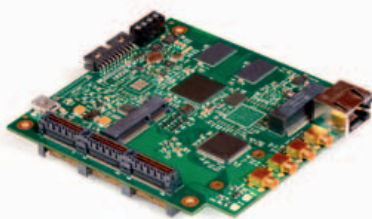
La scheda StreamCorder-SD4, robusta, affidabile e versatile, permette l'utilizzo di quattro telecamere in formato composito PAL/Ntsc/RS170
